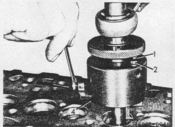
**Hinweis:** Durch Festhalten der Rändelscheibe (2) und Drehen an der Kurbel des Drehwerkzeuges nach rechts, bewegt sich der Drehstahl nach unten bzw. durch Drehen nach links, geht der Drehstahl nach oben.
